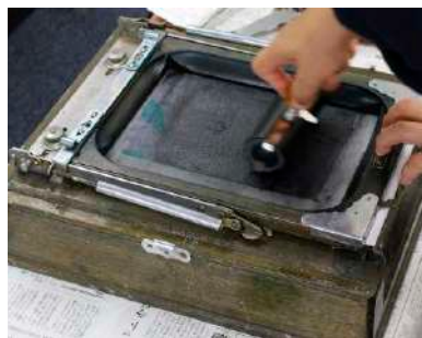
②原紙にあいた穴から出るインクを紙に写して印刷する。
