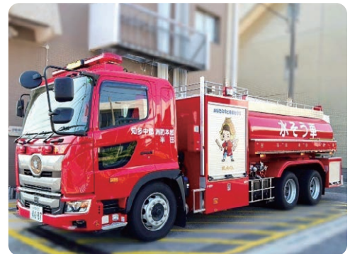
A-2級ポンプを搭載した大型水槽車
