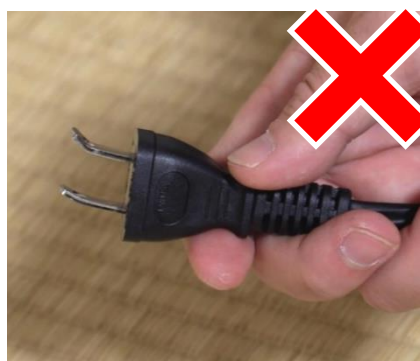
変形した電源プラグは使用しない
