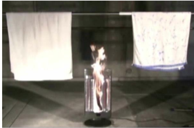
電気ストーブの上で乾かしていた洗濯物が落下して発火
