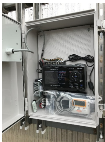
写真 7-3 設置したデータロガーとサーモレコーダーの様子
