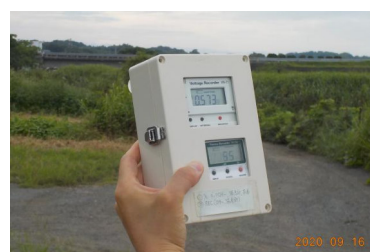
簡易臭気測定器による簡易測定
