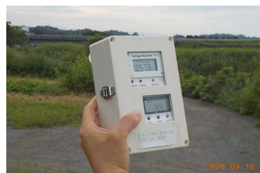
簡易臭気測定器による簡易測定
