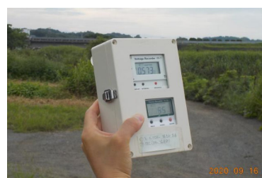
簡易臭気測定器による簡易測定
