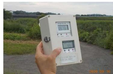
簡易臭気測定器による簡易測定
